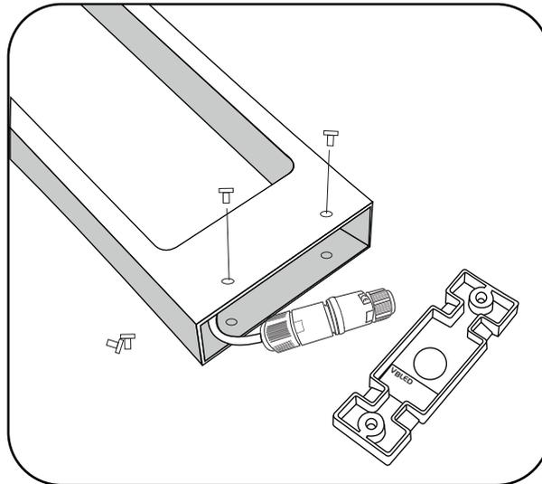
Um den 230V Verbindungsstecker freizulegen, schrauben Sie den Boden der Wegeleuchte ab. Dafür müssen Sie die Schrauben am Fuß der Lampe entfernen.
