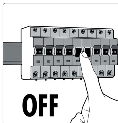
**Vor Anschluss der Wegeleuchte Spannungsfreiheit der Zuleitung prüfen.
