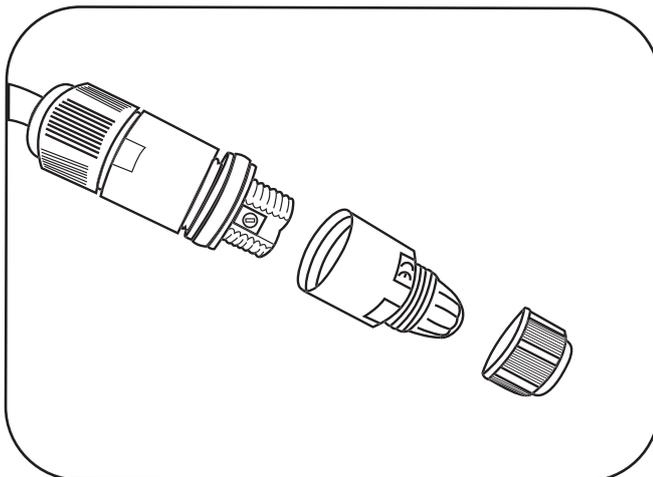
Drehen Sie die einzelnen Komponenten des Steckers ab, bis Sie die drei verschiedenfarbigen Kabel sehen können.
