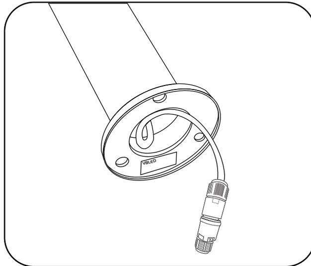
Im Innenraum des Lampenbodens befindet sich der 230V Verbindungsstecker. Holen Sie diesen hervor.
