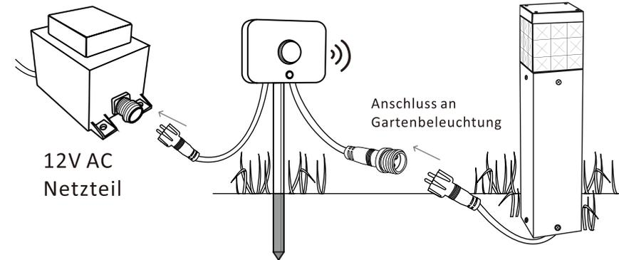
Drehen Sie die Verschlusskappen fest auf, um den Wasserschutz zu gewährleisten.
