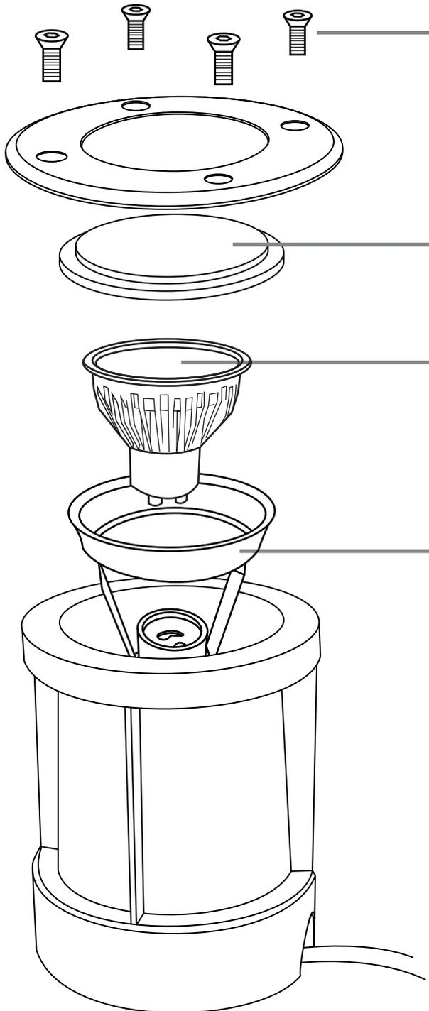
1. Um das Gehäuse der Bodeneinbauleuchte zu öffnen, schrauben Sie die vier Schrauben des Deckels, mithilfe des beiliegenden Schraubenschlüssels ab.
