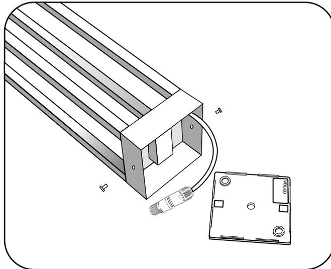
Schrauben Sie den Boden unter der Wegeleuchte ab, um an den 230V Verbindungsstecker zu kommen.
