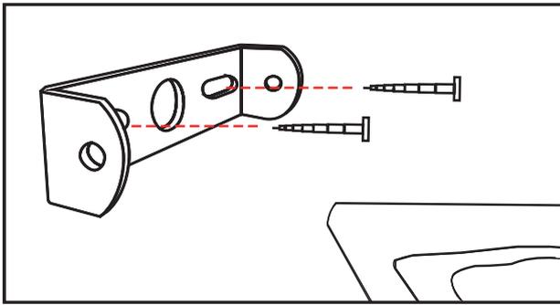
2. Die kleineren Schrauben werden an die Seiten von Montageschelle und Lampe gedreht.
