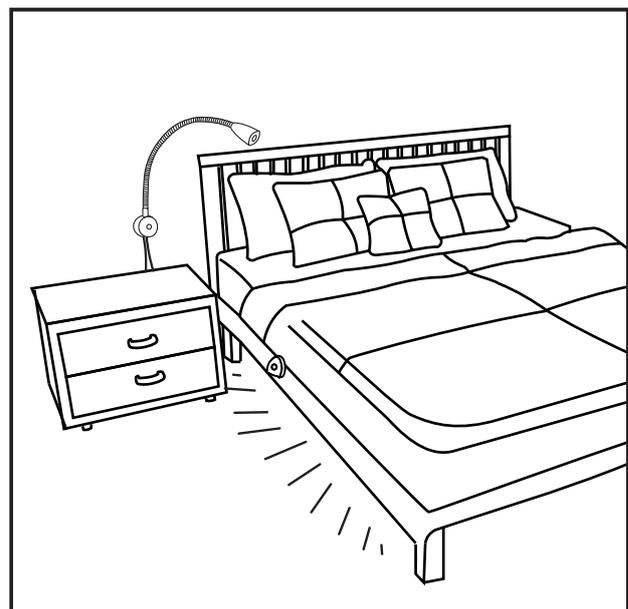
Stellen Sie mit dem Schieberegler am Sensor die gewünschte Beleuchtungszeit des LED-Streifens, sowie die gewünschte Dimmstufe mit dem Drehrad ein.
