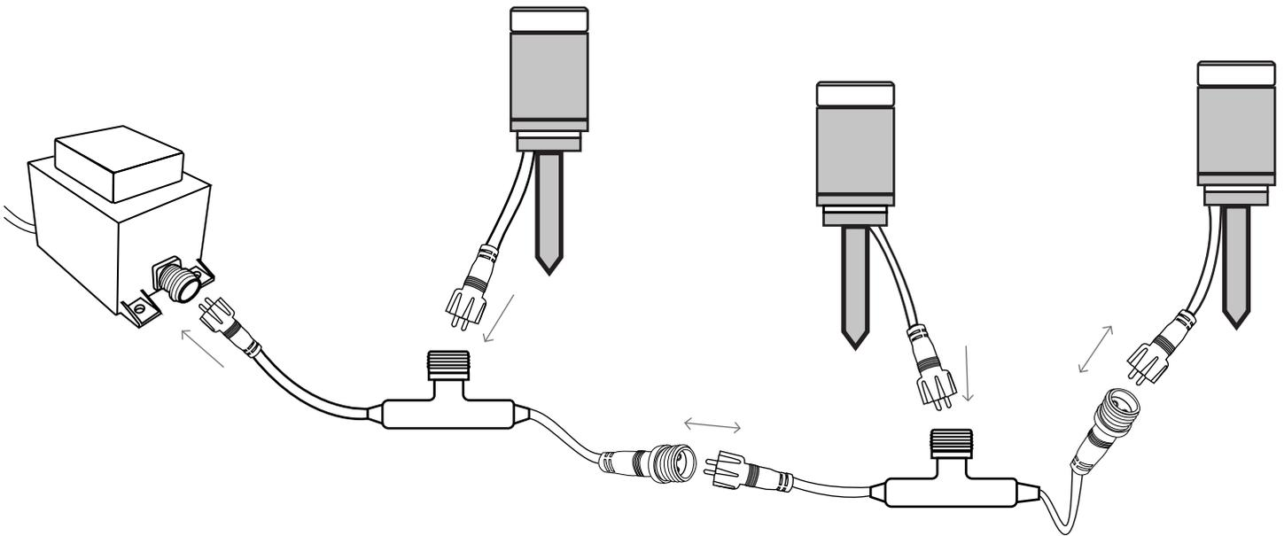
Die IP68 wasserdichten Pug&Play-Steckverbindungen des Kits werden wie abgebildet einfach zusammengesteckt und fest verschraubt.
