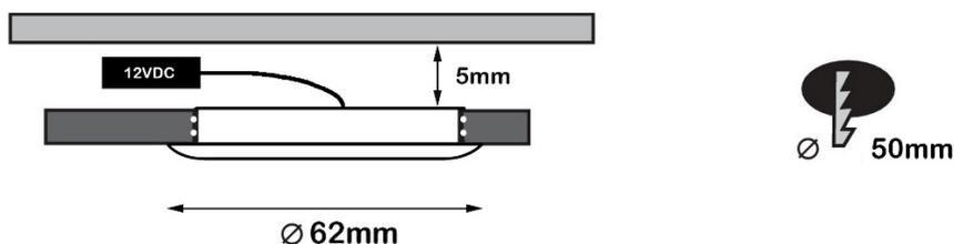
Das Produkt ist insbesondere für den Einbau in Fußböden/Wänden geeignet.
