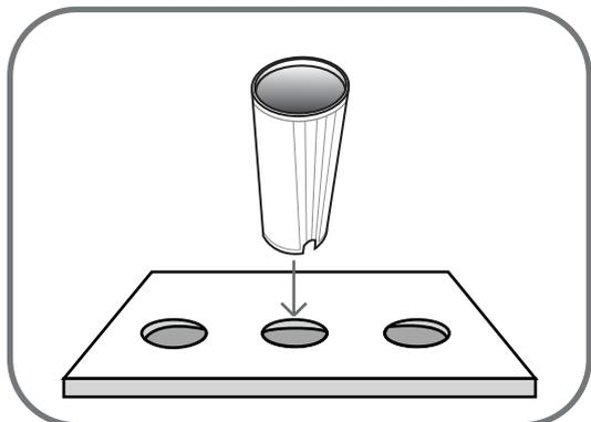
2. Schrauben Sie die Verschlussklappe der Leuchte ab. Das Innenleben der Lampe wird, mit den Steckern voran, in die befestigte Hülse des Strahlers gesteckt.
