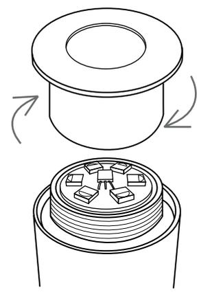
3. Leuchtmittel des Minispots ist wechselbar. Es wird, wie abgebildet, in die Vorrichtung gesteckt. Das RGB+W Leuchtmittel erhalten Sie bei uns unter der Artikelnummer 24014.
