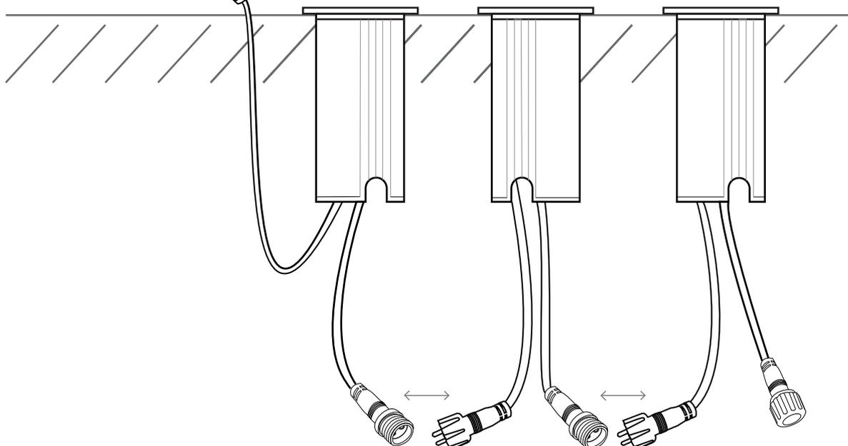
1. Bohren Sie Löcher (Breite: Ø38mm, Tiefe: 72mm) in die Plattform der gewünschten Installation. Die Außenhülle der Einbauleuchte wird dann, wie abgebildet, in das Loch gesteckt.
