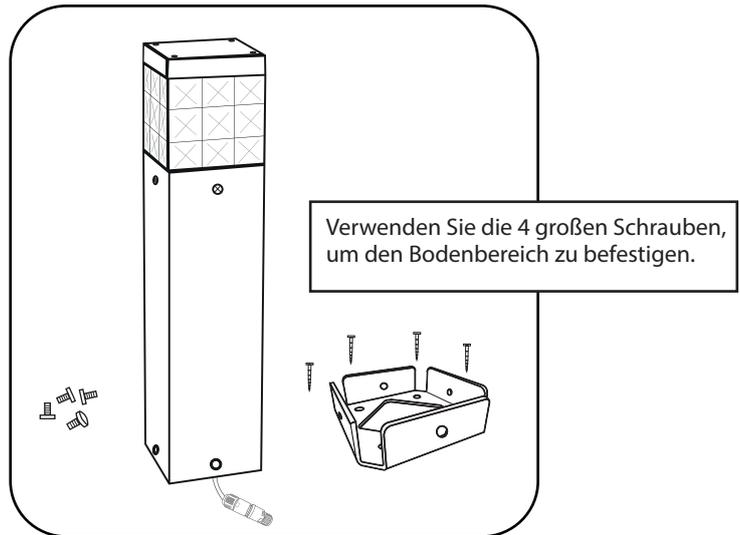
Schrauben Sie den unteren Teil der Lampe ab und entfernen Sie den Bodenbereich, damit Sie an den 230V Steckverbinder gelangen.
