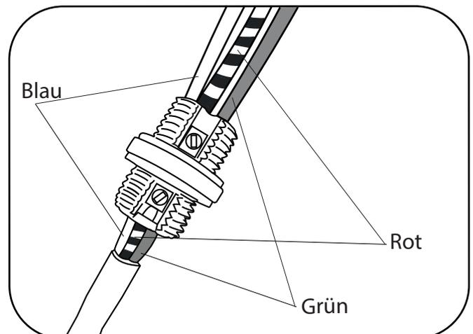
Beim Verbinden von Stromkabel und Stecker, stellen Sie sicher, dass die Farbe der einzelnen Kabel, jeweils mit der Farbe des Steckerkabels übereinstimmt.
