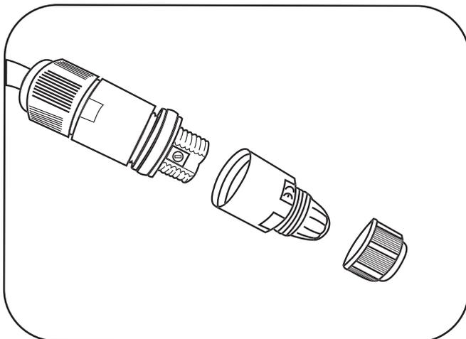
Die einzelnen Komponenten des Steckers werden abgedreht, bis Sie die drei verschiedenfarbigen Kabel sehen können.
