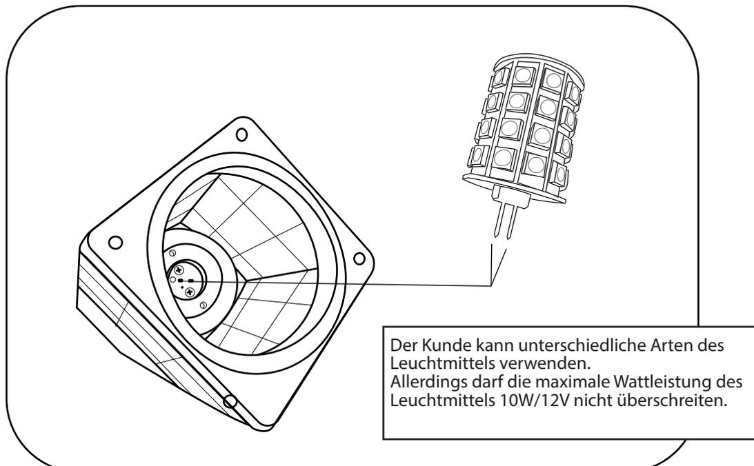
Im Inneren der Wegeleuchte sehen Sie die Haltevorrichtung für das Leuchtmittel, welche mit zwei kleinen Löchern definiert ist. Die beiden Kontakte des Leuchtmittels werden in diese Vorrichtung gesteckt.
