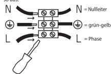
Die Schrauben des Eingangs werden zuerst aufgedreht. Zunächst wird das abisolierte Kabel in die jeweilige Verbindung gesteckt (z.b. blaues Kabel in den N Eingang). Zuletzt wird die Schraube wieder ordentlich festgeschraubt.
