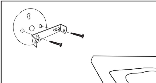
2. Die kleineren Schrauben werden in die seitlichen Öffnungen gedreht, um so die Montageschelle von innen an die Lampe zu fixieren.
