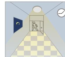
Beim Verlassen des Erfassungsbereiches bleibt das Licht noch für einen, von Ihnen bestimmten, Zeitraum eingeschaltet und dimmt auf die gewünschte Stufe runter.
