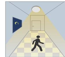
Mit aktiviertem Helligkeitssensor schaltet sich das Licht bei Dämmerung/ungenügend Licht automatisch ein.
